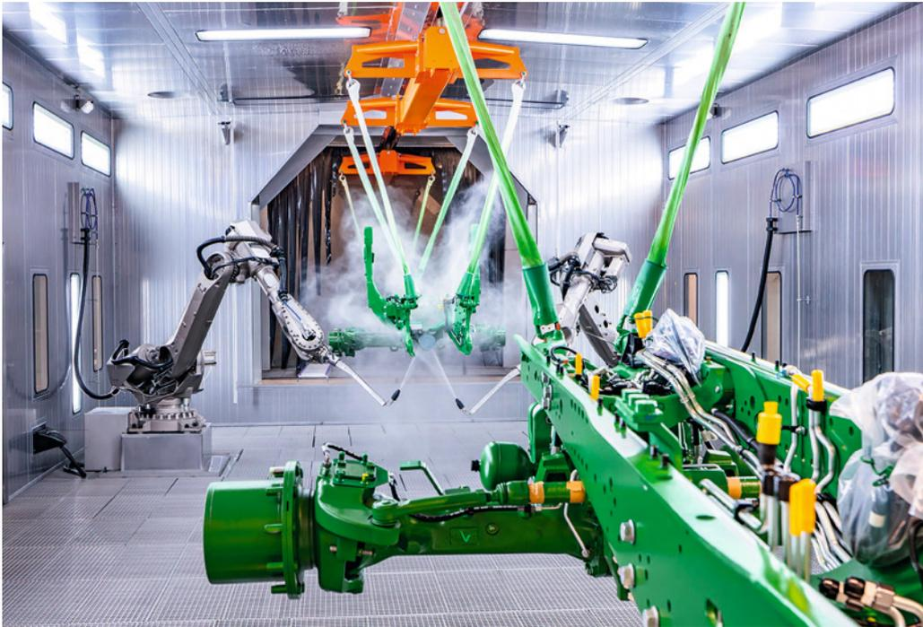
Der Vorbehandlung, die in sieben Stufen erfolgt, ist eine Roboterreinigung vorgeschaltet.
